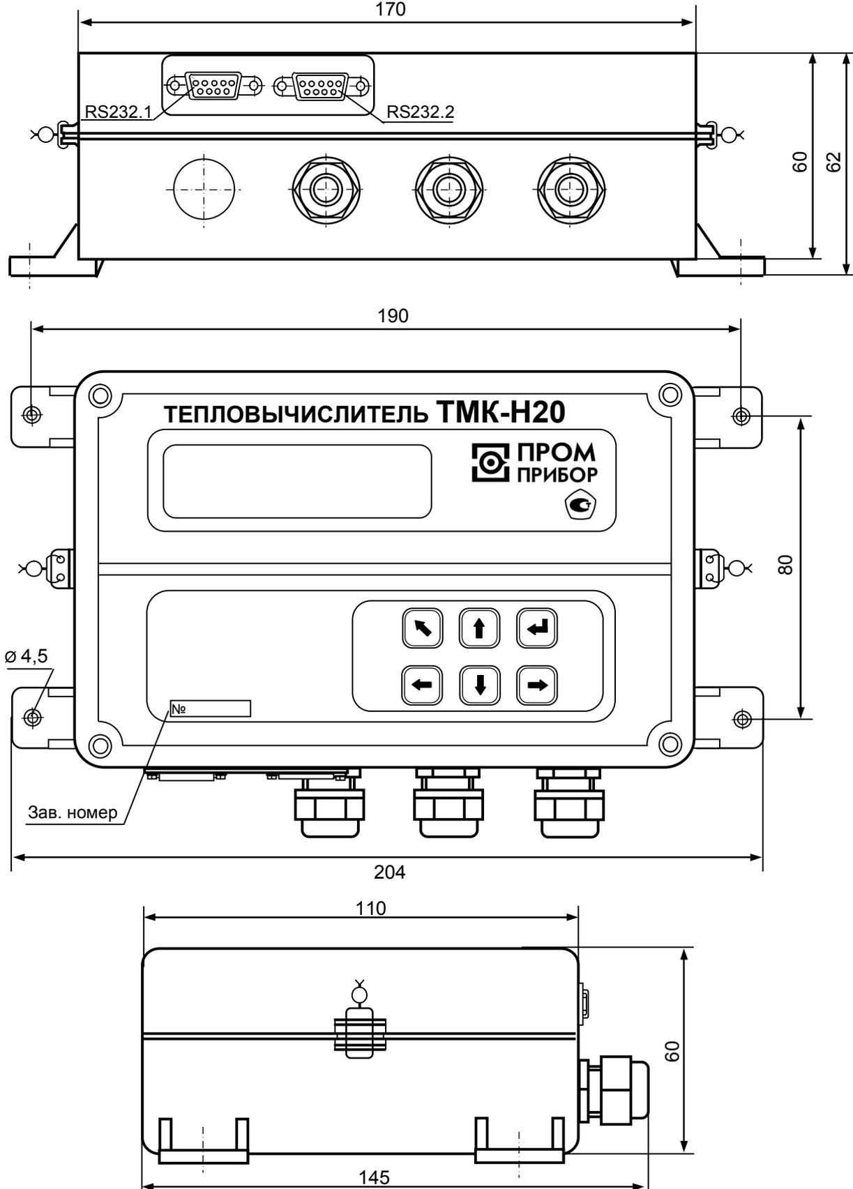
Примечание - неиспользуемые разъемы интерфейсов RS232.1 и RS232.2 и кабельные вводы должны быть закрыты штатными заглушками (на рисунке не показано).
