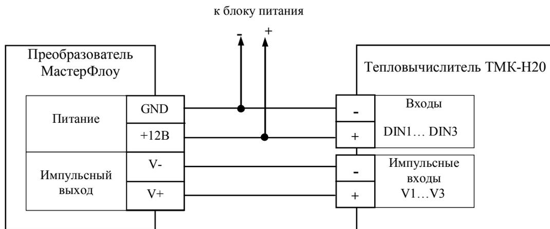
Пример подключения преобразователя МастерФлоу с импульсным выходом к ТМК-Н20 с обеспечением контроля напряжения питания
