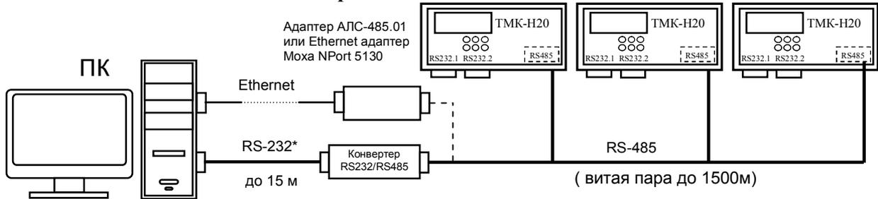
**Подключение ТМК к ПК через проводную или беспроводную линии связи**
