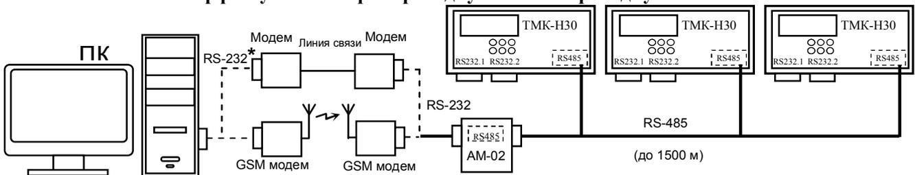
**Подключение ТМК к диспетчеру по интерфейсу RS 232 через GPRS модем и Интернет**
