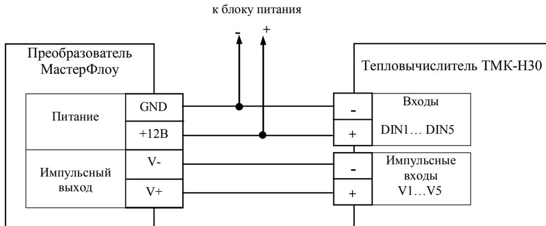
Пример подключения преобразователя МастерФлоу с импульсным выходом к ТМК-Н30 с обеспечением контроля напряжения питания
