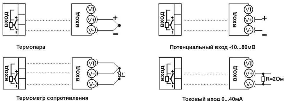
Рисунок 7 – Схемы подключения датчиков
