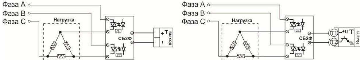
Использование двухфазных силовых блоков для управления трехфазной нагрузкой.
