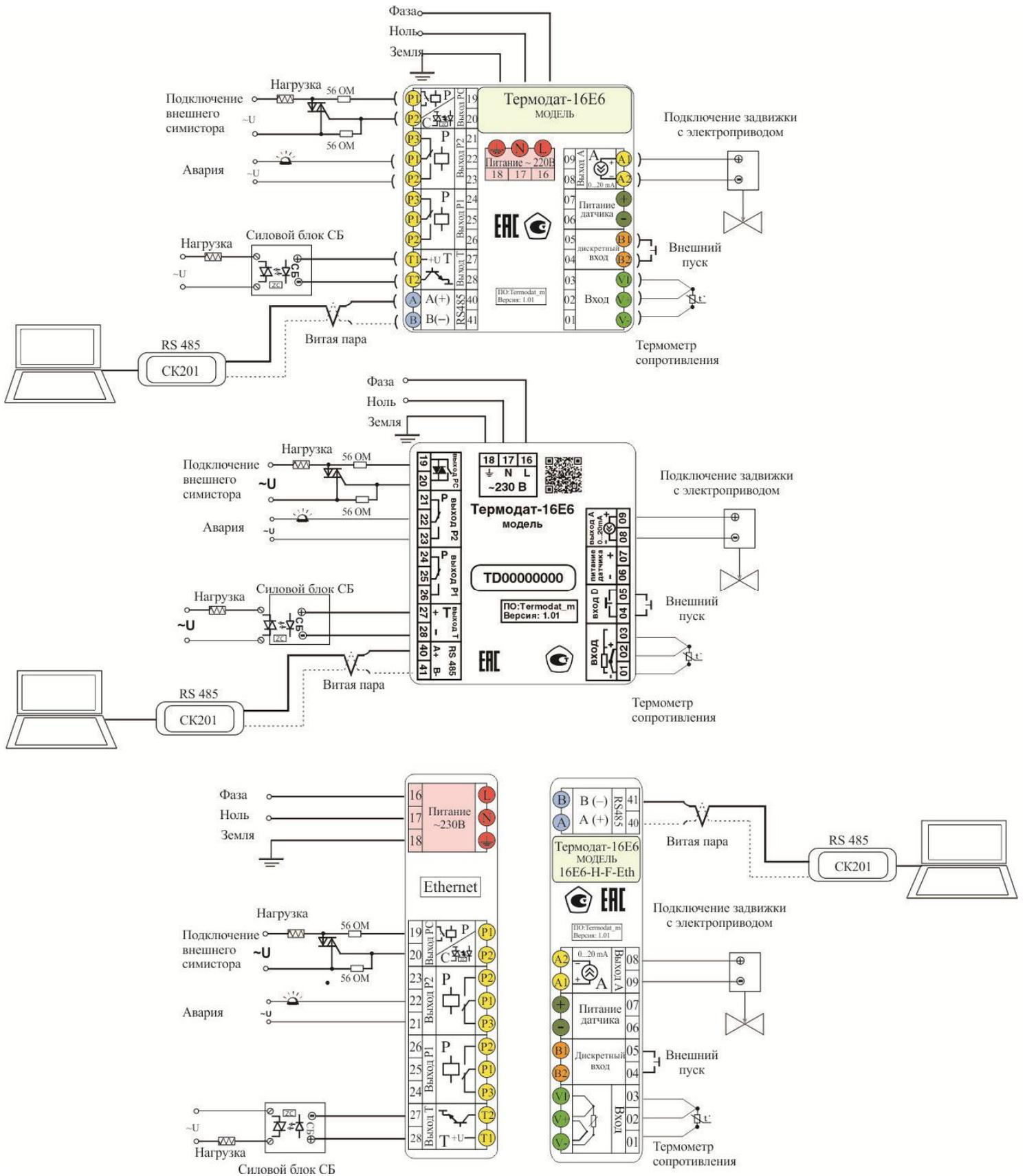
Рисунок 12 – Схема подключения прибора
