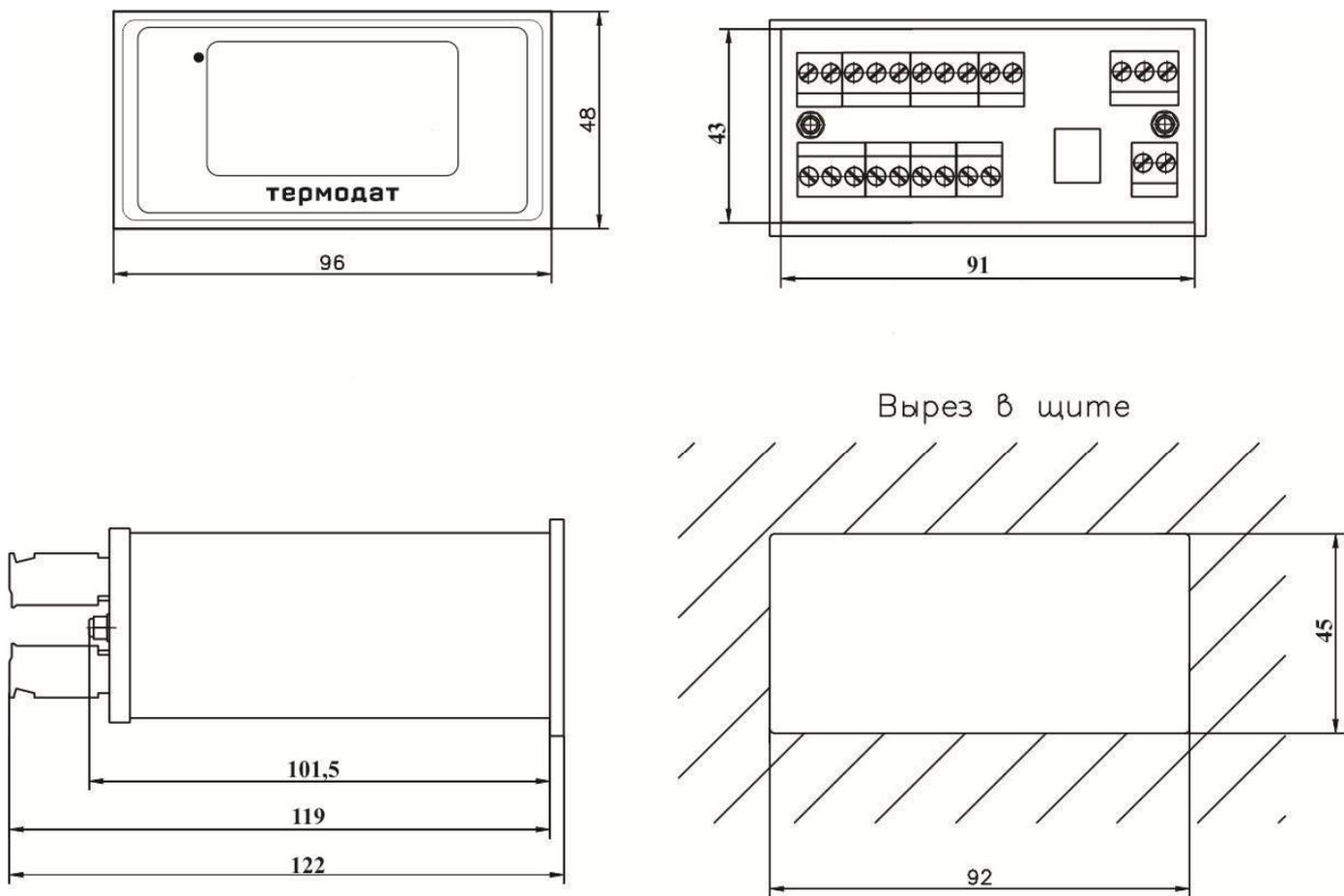
Рисунок 16 – Габаритные размеры прибора
