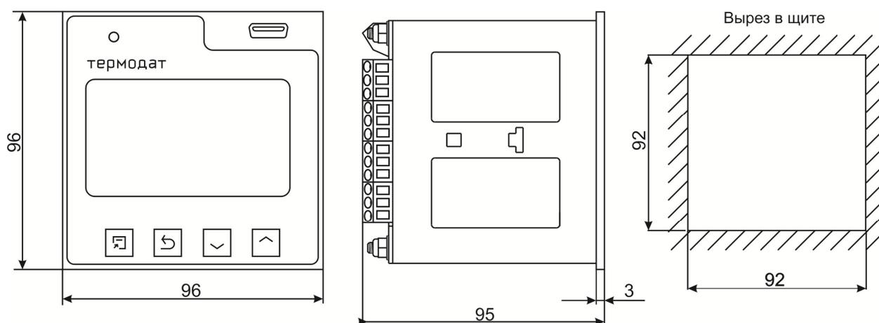
Рисунок 13 – Габаритные размеры прибора Термодат-16Е6/...../(F) или Термодат-16Е6-А-(F)-(Eth)
