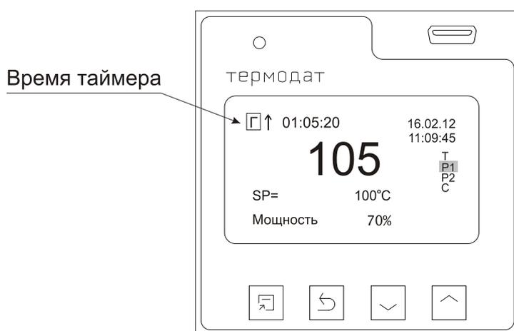
*Рисунок 6 – Внешний вид прибора с включенным таймером*
