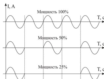
При **методе равномерно распределенных рабочих сетевых периодов (РСП)** ток через нагреватель периодически включается на один или несколько сетевых периодов. Мощность нагревателя испытывает меньшие колебания во времени, чем при использовании ШИМ. Этот метод очень хорош в лабораторных условиях при малых мощностях нагревателя. Не используйте метод при мощностях более 5 кВт. Недопустимо использование метода РСР при индуктивной нагрузке.
