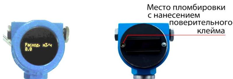
Рисунок 3 – Электронный преобразователь ЭП
